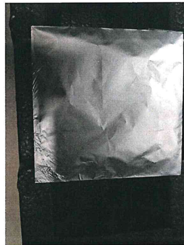
Abb. 2: Beschichtete Glasplatte aus Abb. 1 nach Sublimation des Produktes
